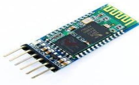
Fig 2.1(b) Bluetooth module HC 05
